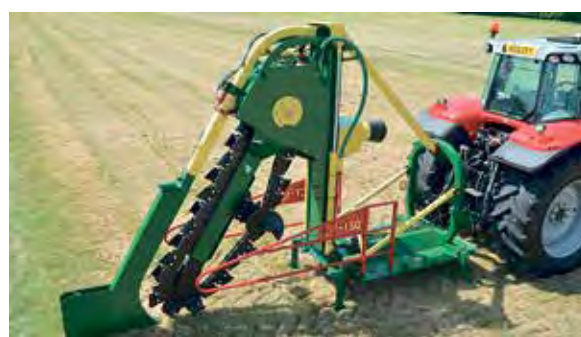
La trancheuse polyvalente CT150 de Shelton creuse jusqu'à 1,5 m maximum.
