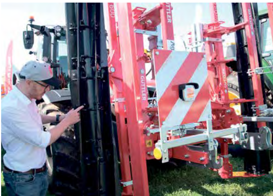
Laurent Tonglet présente les lames hélicoïdales qui, boulonnées, peuvent très facilement se remplacer.
