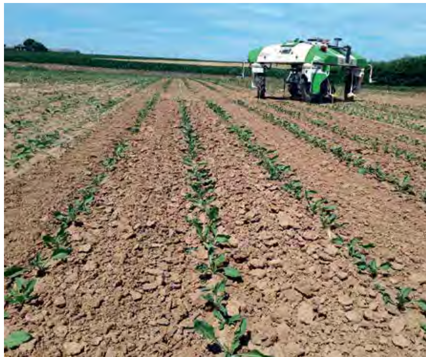
Le projet PhytoRé vise à tester au sein d'un réseau d'agriculteurs des pratiques agricoles visant à diminuer l'utilisation de PPP. Sur cette photo, Dino, robot de désherbage autonome du CRA-W, réalise un désherbage ciblé en culture légumière. Source : CRA-W ©
